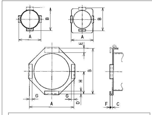
左右及び下の分離した受け金具に対し、フィルタホルダを上から差し込む構造のもの。 抜け止め・保持方法は問わない。
