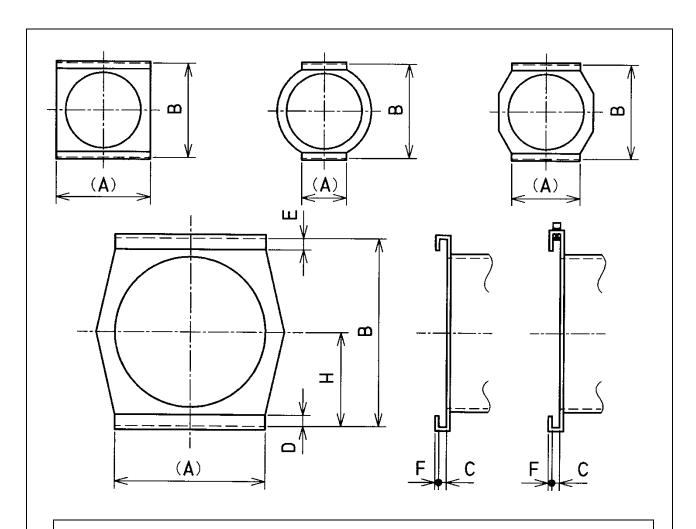
上下の受け金具に対し、フィルタホルダを左右から差し込む構造のもの。 抜け止め・保持方法は問わない。
