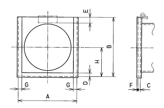
左右及び下の袋状の受け金具に対し、フィルタホルダを上から差し込む構造のもの。 抜け止め・保持方法は問わない。
