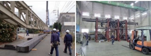
天反用トラスフレーム実負荷試験 ガーターレール関連実負荷試験
