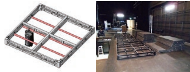
3Dによる鋼製フレーム検討図と完成品
