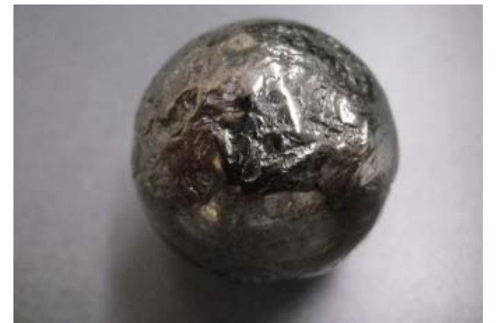
図1 既設ボールナット内の鋼球
