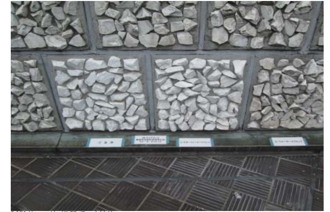
試験施工 (無機質系の材料)
