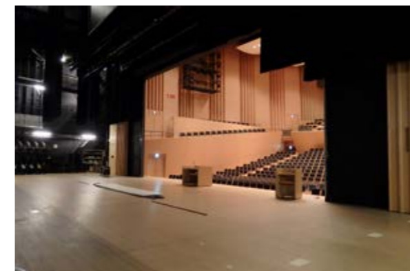
写真4：舞台側から客席を見ると、上手下手に音響反射板の前方部分が折り畳まれて収納されている
