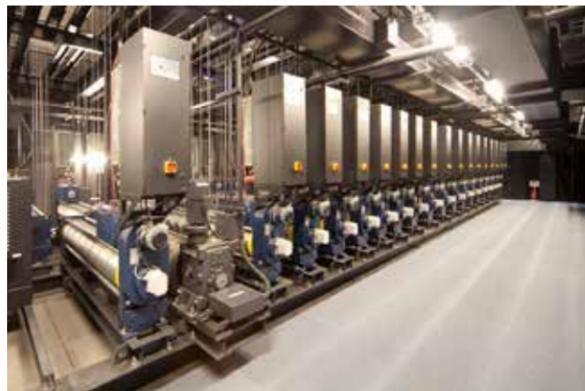
写真-1 静音型可変速電動巻取りウインチ
